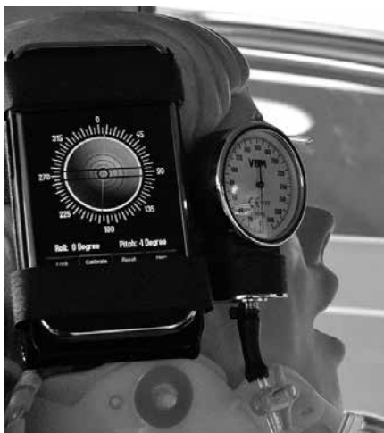
Zdjęcie 4. Urządzenia służące do pomiaru odchylenia głowy i nacisku na język (Źródło: materiał własny)
