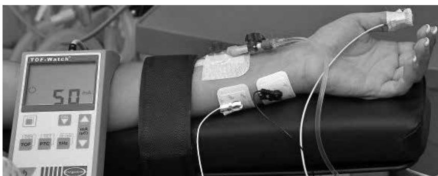
Rycina 2. Akcelerometr TOF-Watch SX (Organon, Ireland) umożliwia stymulację za pomocą pojedynczych pobudeń (STS), ciągu czterech (TOF) i podwójnej salwy (DBS), a także określenie liczby potężcowej (PTC). Ocena odpowiedzi na stymulację odbywa się w oparciu o metodę akcelerometryczną.
