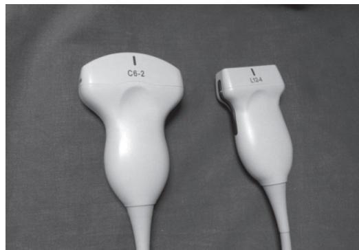
Zdjęcie 1. Głowice aparatu ultrasonograficznego wykorzystywane do nawigacji igły podczas kaniulacji naczyń (liniowa i konweksowa)
