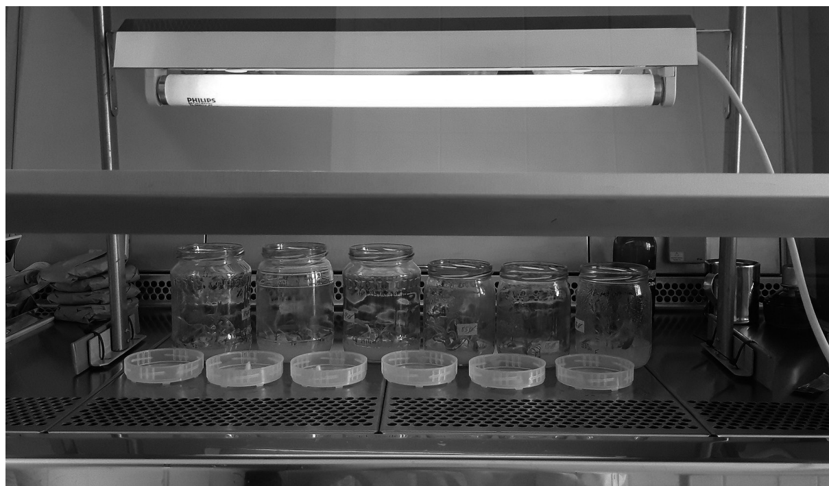
Zdjęcie 1. Aparatura do elicytacji kultur in vitro promieniami UV-B (konstrukcja własna)
